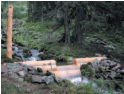
Naturnahes Messwehr mit Pegel und Datensammler an der Schönebenquelle in den Seckauer Tauern
