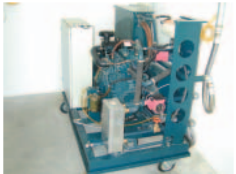
POEM – Pilot-BHKW-Anlage im Testbetrieb
