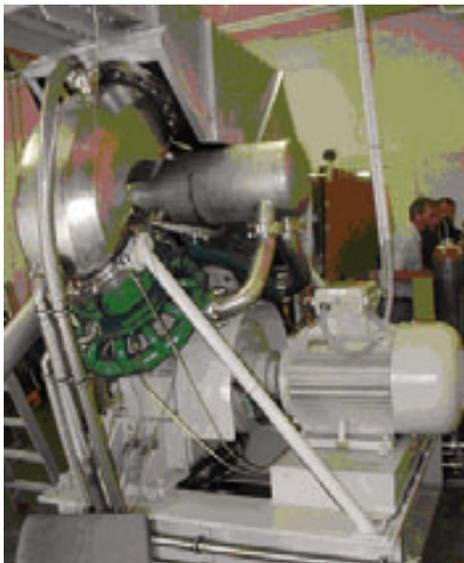
*Biomasse-Stirlingmotor mit einer Nennleistung von 30 kW in einer Testanlage bei Joanneum Research, Juli 2002*
