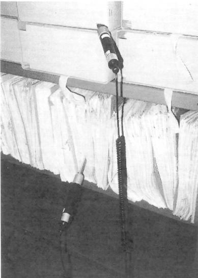
*Bild 4: Schwertfühler (Rotronic, Typ: SGC-N2-26-K) im Meßeinsatz*
