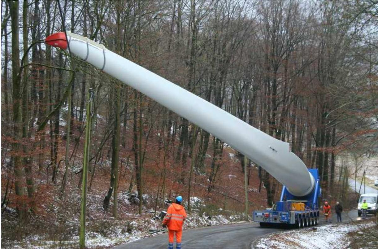
Abb. 1: Rotorblatttransport mit Anheben des Rotorblatts, aus [1]
