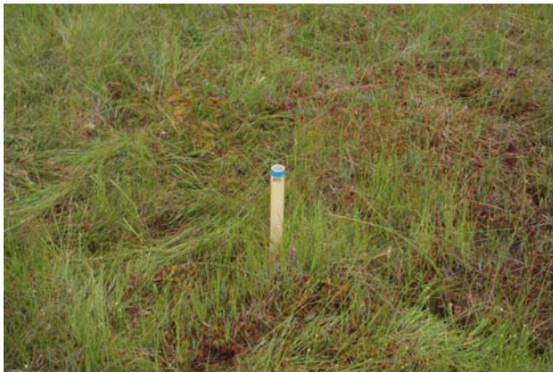
Abb. 9: Kunststoffpegelrohr mit Schlitz-Perforation zum Einsetzen (Aufhängen) der Autopegel (hier noch ohne Sicherheitsverschluss) bzw. Autopegel („Diver“) und Baropegel der Fa. Eijkelkamp, NL.
