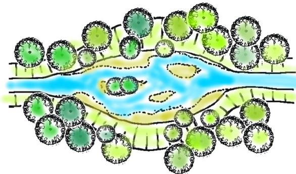
Schemazeichnung einer lokalen Aufweitung mit abgeflachten Uferböschungen, Inseln und Kiesbänken. Um einer Ufererosion vorzubeugen, sind gefährdet Uferbereiche durch einen breiten Ufergehölzsaum gesichert
