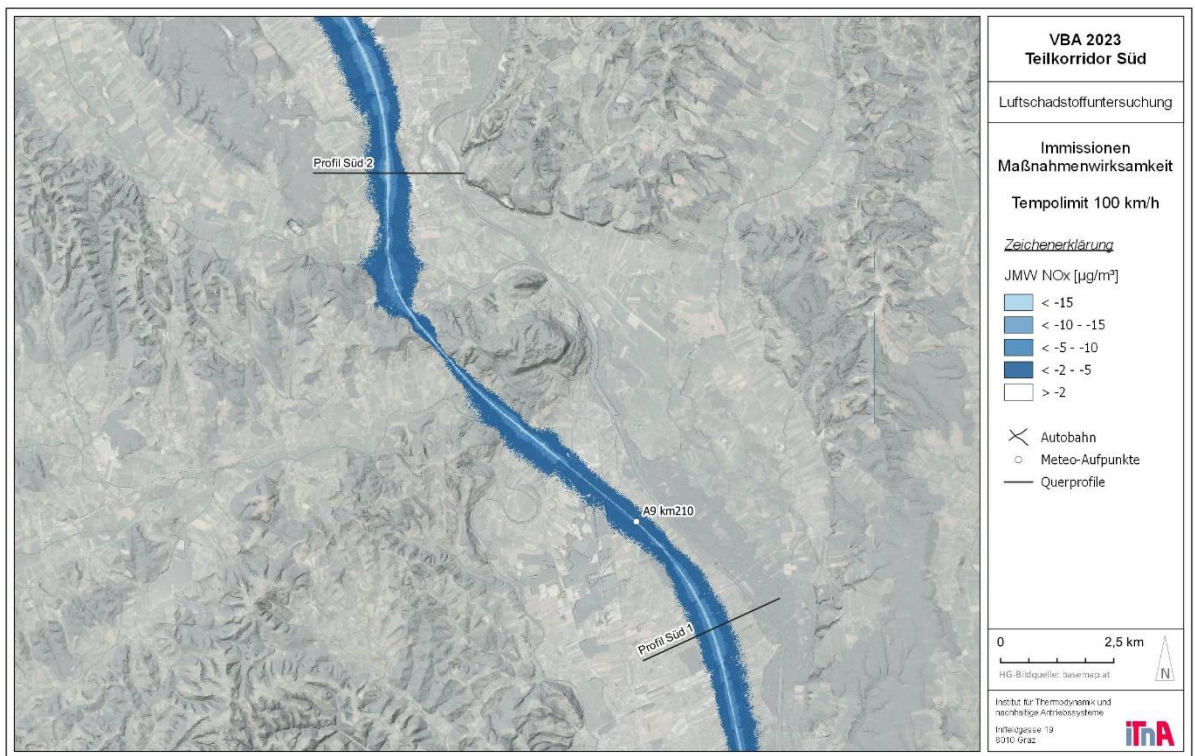
Abbildung 97: Wirksamkeit des statischen Tempolimits von 100 km/h auf den durchschnittlichen NO x -Beitrag für den Teilkorridor Süd.
